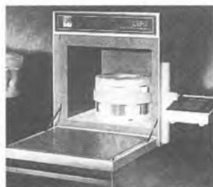
**F8. Muflas para Determinação de Cinzas por Micro-ondas da Milestone**
