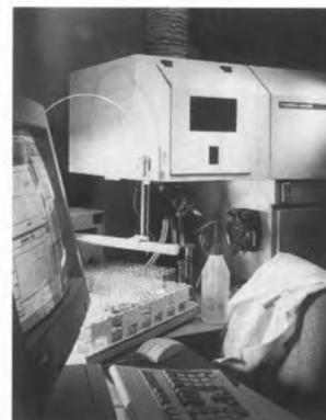
O espectrómetro ICP- HORIZON da ARL é um instrumento completamente automático sequencial de bancada com o novo software EVOLUTION em ambiente Windows, que inclui um inovador sistema de introdução da amostra e está disponível com vários acessórios de instalação simples tal como gerador de hidretos e nebulizador ultrassónico. A sua distância focal de 1 metro, permite a obtenção simultânea de uma alta resolução e elevada performance óptica.
