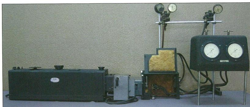
figura 14 Espectrofotómetro Beckman DU com acessório de chama.
