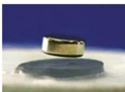
Levitação magnética de um íman acima de um supercondutor
